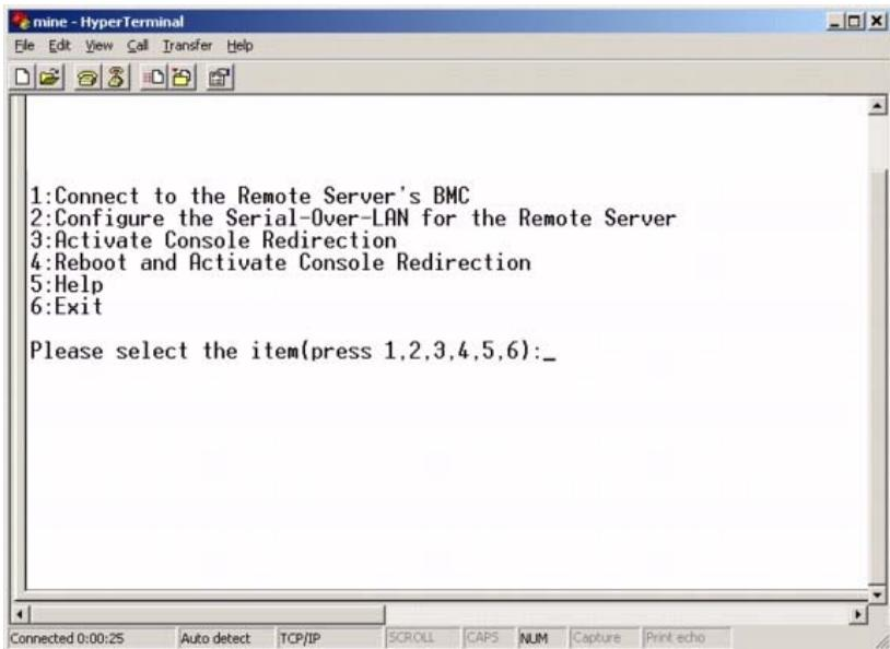
El menú principal del proxy SOL permite cambiar la configuración de SOL del BMC de un sistema administrado remoto, reiniciar el BMC remoto o activar la redirección de consola.
