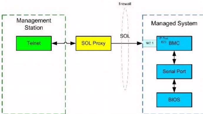
El esquema de comunicación de Proxy SOL permite ver y configurar la configuración del BIOS de un sistema administrado, así como restablecer el sistema administrado de manera remota mediante un cliente Telnet. Proxy SOL se instala como un servicio de daemon y se inicia automáticamente cada vez que se inicia el sistema. Proxy SOL acepta únicamente una sesión de Telnet cada vez.
